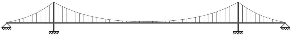
Abb. 23: statisches System eines Seiltragwerks (Dinkler 2022, S. 106)
